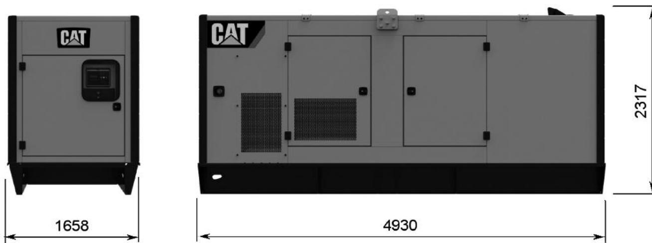
Poids approximatif de l'ensemble de capotage: 5280 kg (11 640 lb). Le poids exact varie selon les options. Le poids du capotage comprend: le capotage insonorisé, le circuit d'échappement, la base et le groupe électrogène.
