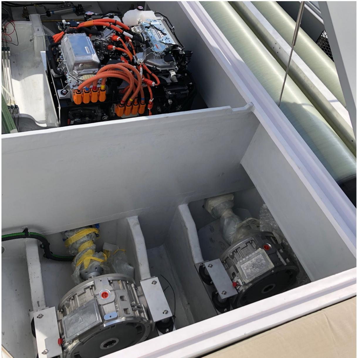
Le prototype The New Era d'Hynova Yachts avec son REXH2, ses moteurs électriques BorgWarner et les réservoirs d'Hydrogène Hexagon © Exequiel Cano Lanza
