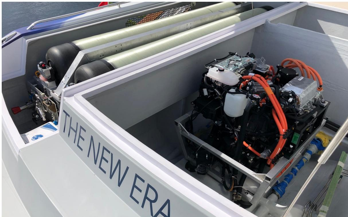
Le prototype The New Era d'Hynova Yachts avec son REXH2 et les réservoirs d'Hydrogène Hexagon © Exequiel Cano Lanza
