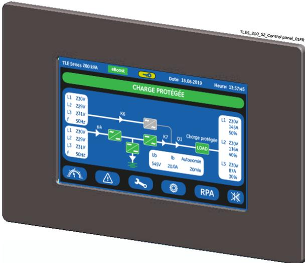
Le tableau de contrôle, situé sur la porte antérieure de l'ASI, est l'interface de communication du système ASI et il est composé des suivants éléments :
